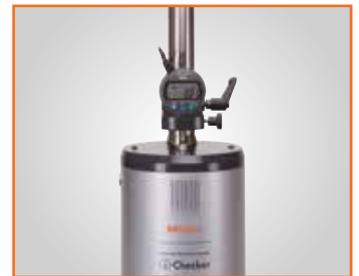
Kalibrierung unter Verwendung einer digitalen Messuhr
