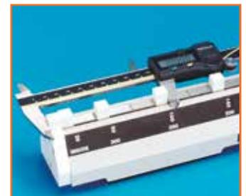
Genauigkeit des Messschiebers überprüfen (Außenmessung)
