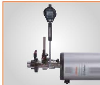
Kalibrierung unter Verwendung eines Innenmessgerät-Zubehörs (Modell C)
