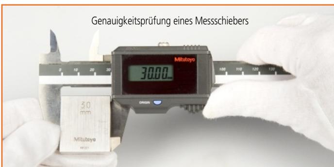
Genauigkeitsprüfung eines Messschiebers
