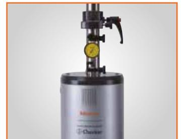
Kalibrierung unter Verwendung eines Fühlhebel-Zubehörs (horizontales Modell)
