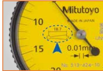
Die Länge des Messeinsatzes ist auf der Skala angegeben.
