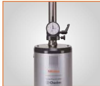
Kalibrierung unter Verwendung einer analogen Messuhr
