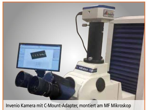
Invenio Kamera mit C-Mount-Adapter, montiert am MF Mikroskop
